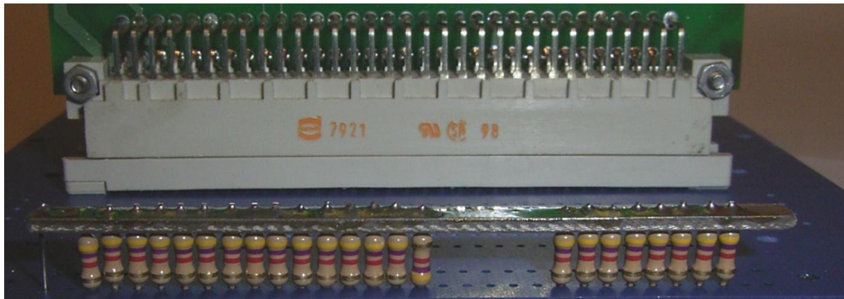
Mögliche Montage der Abschlusswiderstände (hier allerdings noch ohne die Leitung 15C)
